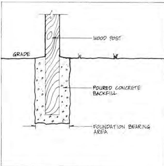
Figure 4.10. Concrete Backfill
