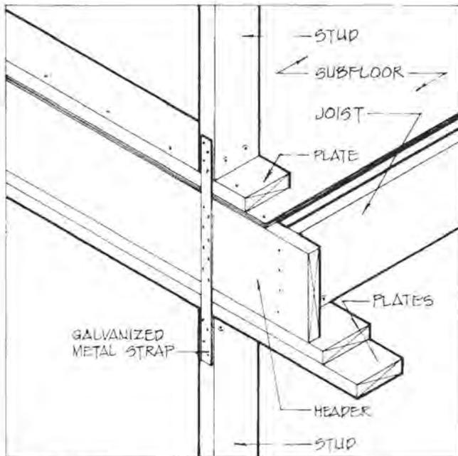
Figure 4.44. Stud-to-Stud Connections
